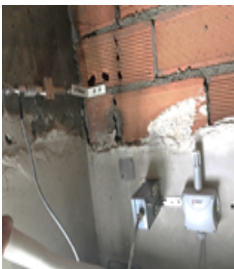
Punto de medida con fisurómetro, inclinómetro y sonda de temperatura y humedad. Evaluación temporal de la inclinación de la fachada
