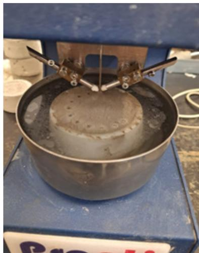
*Ensayo de tiempo de fraguado de morteros con*
