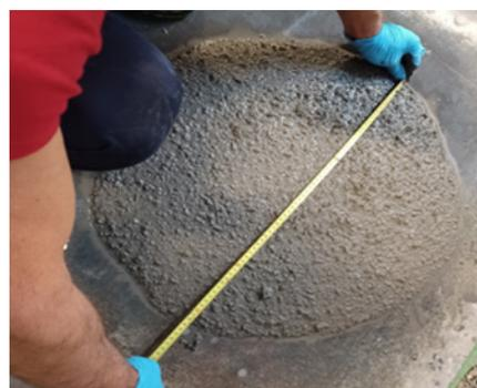
*Hormigón con agregados reciclados*
