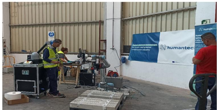
*Pruebas definitivas de los robots llevando a cabo reparación de juntas en losas de hormigón de manera autónoma y de controlada remotamente por un trabajador previamente instruido en el manejo del sistema*
